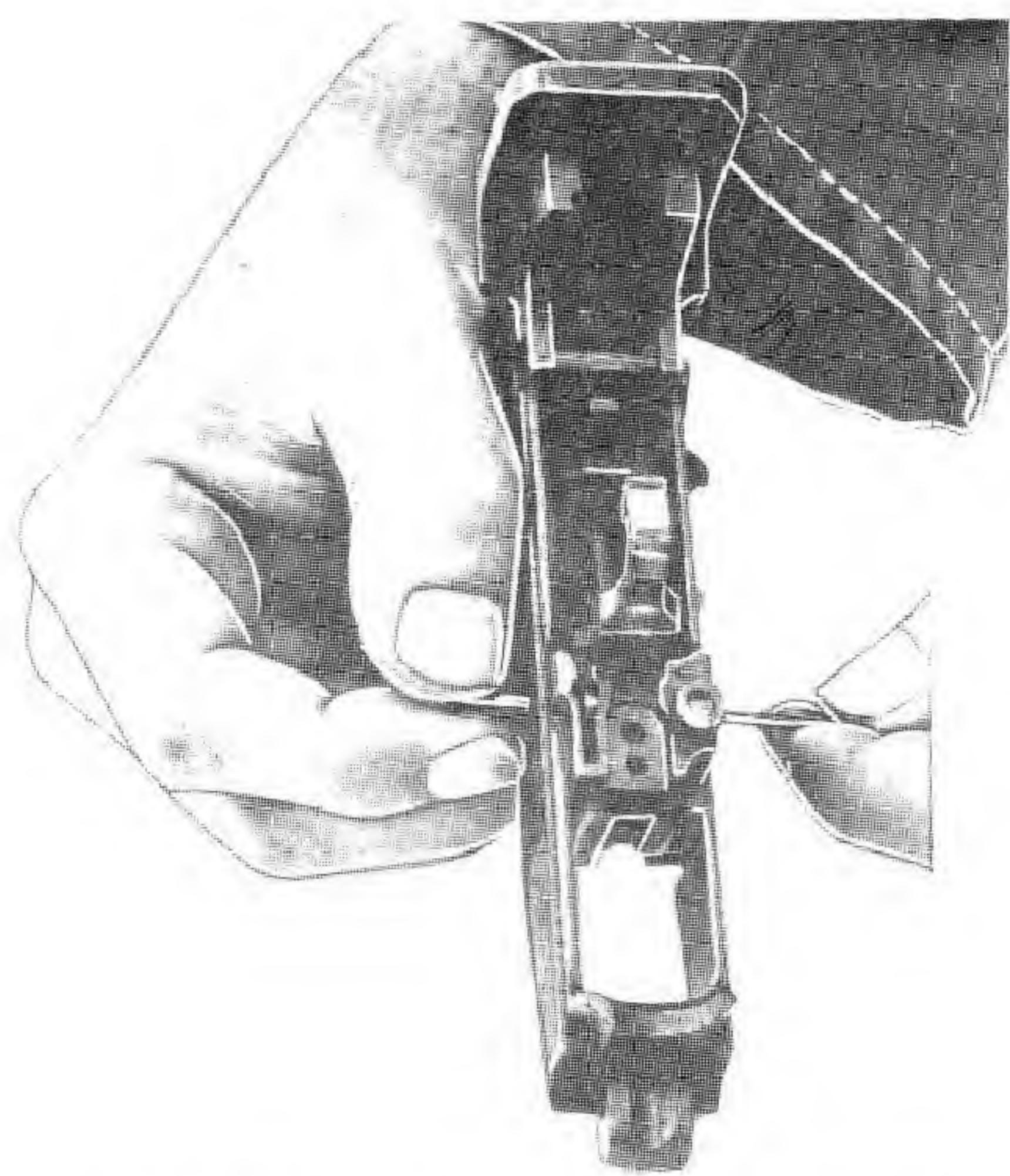
Sl. 82 – Odvajanje osovine udarača od usadnika
